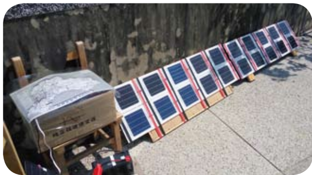
▲ 南投縣國姓國中組裝二十片太陽能小模組，用來充12v電瓶
